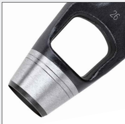
konischer Schneidkopf, geschliffen und blank, innen leicht konisch zum Entfernen der Ausschnitte
