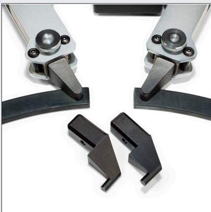
wechselbare Spitzenpaare für unterschiedliche Durchmesserbereiche
