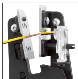
Abisolieren durch Formmesser Stripping with profile blades
