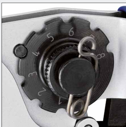
Crimpdornzustellung über Selektor mit 8 Positionen analog MIL/SAE AS22520
