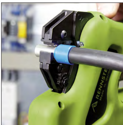
Crimpen von Aderndhülsen bis zu 50 mm 2 Crimping of ferrules up to 50 mm 2
